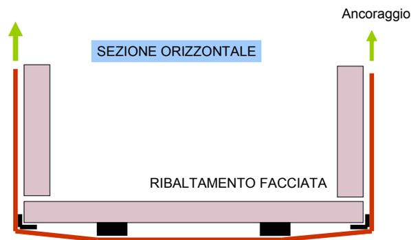
FIG. 9 - Conformazione delle cinturazioni secondo poligono funicolare
