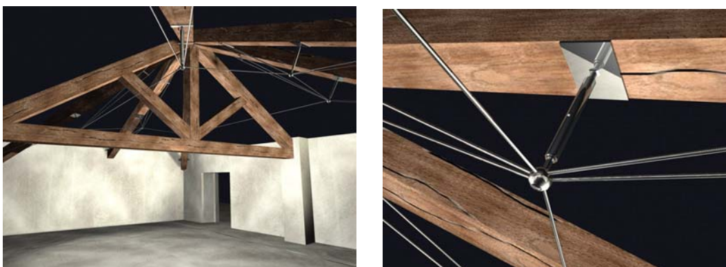
Figura 12 a,b. Proposta progettuale di consolidamento della copertura, consistente nella realizzazione di una struttura reticolare tridimensionale costituita da tiranti di piccolo diametro nella parte inferiore della copertura, forzati a sostegno dei puntoni mediante aste telescopiche.
