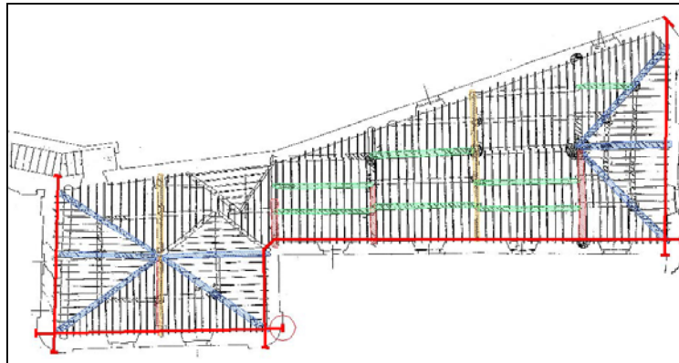
Figura 5. Gli elementi della copertura lignea oggetto degli interventi di consolidamento o restauro (in giallo le capriate, in blu i falsi puntoni, in rosso i puntoni ed in verde le terzere)
