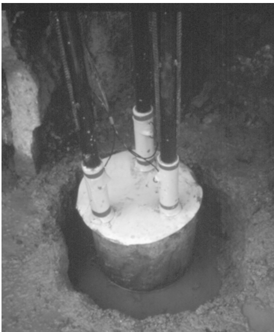
Fig. 7. ISTALLAZIONE DEI DINAMOMETRI PER LA MISURA DELLO SFORZO TRASMESSO AI PALI
