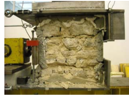
Figura 9 : Prove di taglio-compressione per campioni iniettati (sx), quadro fessurativo a collasso (dx)
