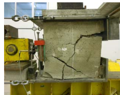
Figura 12 : Prove su campioni fibrorinforzati (sx), quadro fessurativo a collasso (dx)
