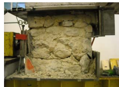
Figura 10 : Prove di taglio-compressione per campioni iniettati (sx), quadro fessurativo a collasso del campione rinforzato con rete in fibre di basalto (dx)
