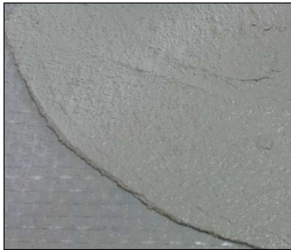
Figura 1: Esempio di FRCM con rete in fibra di vetro immersa in una matrice a base calce.
