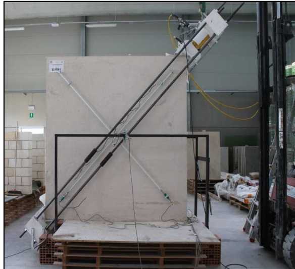
Figura 16 : Prove di compressione diagonale su pannelli in muratura di pietra calcarea.
