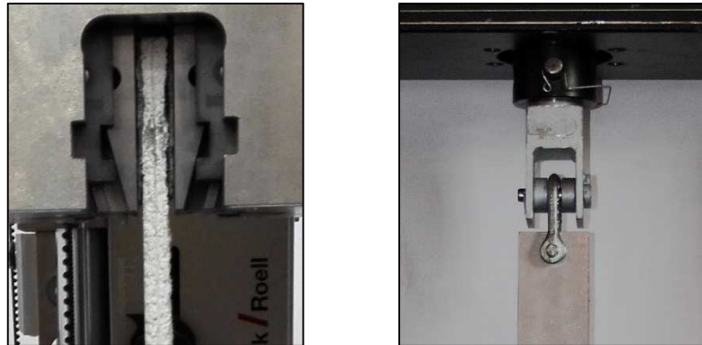
Figura 8 : Setup per prove di trazione su campioni di FRCM: clamp ( sinistra ) e clevis ( destra ).
