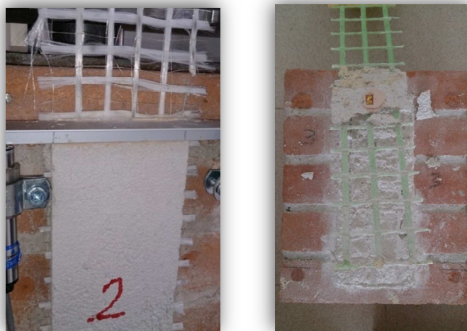
Figura 7 : Dettaglio della crisi per aderenza di campioni di FRCM.
