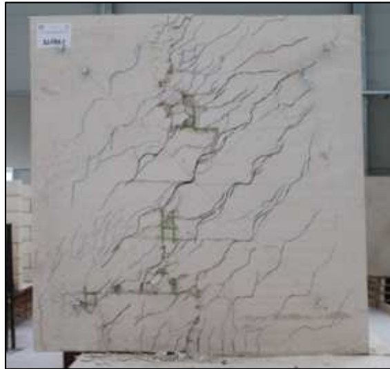
Figura 14 : Pannello murario rinforzato con FRCM sottoposto a test di compressione diagonale.
