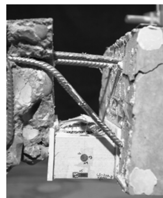
Figura 10: Giunto ibrido FRP/acciaio
