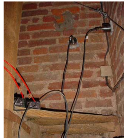
Figura 20: ubicazione di alcuni accelerometri per la prova dinamica
