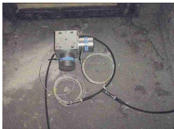
Figura 5: Accelerometri A - B
