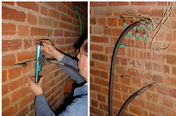
Figura 19: Prova con martinetto piatto semplice e doppio
