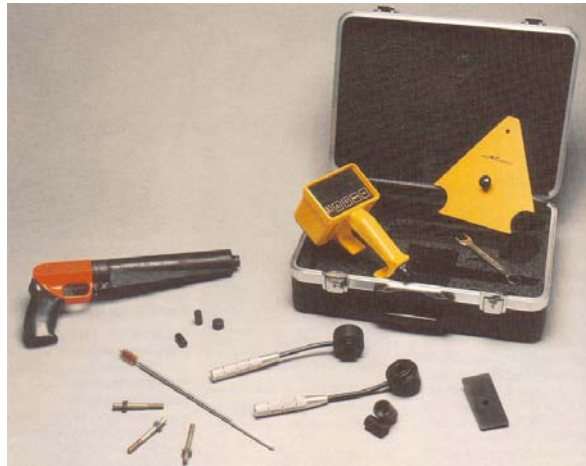
Figura 3: Strumentazione per la prova di penetrazione con sonda Windsor.
