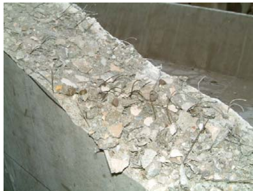
Figura 16: Distribuzione delle fibre nella superficie della fenditura
