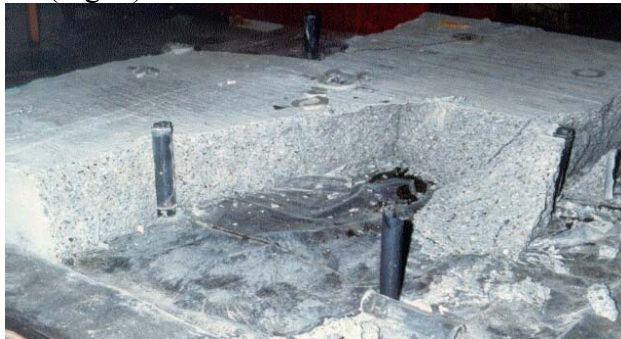
Figura 8: Lastra in calcestruzzo normale dopo la rottura.
