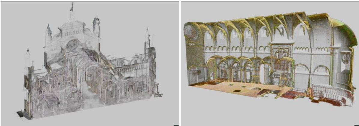
Restituzione degli interni del Duomo con rilievo laser-scanner.
