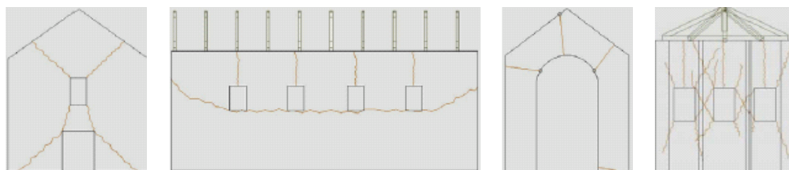
Figura 2: Linee di frattura (FL) in Macro-Elementi Strutturali (SM-E) per azione sismica trasversale all'asse basilicale.
