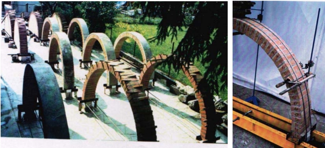
Figura 6. Arco armato: Modelli di archi in muratura predisposti per prove a scala reale
