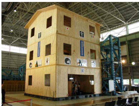
Figura 4. Edificio sottoposto a prova sopra la tavola vibrante del NIED (configurazione C).
