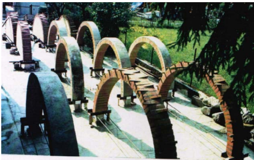
Arco armato: Modelli di archi in muratura predisposti per prove a scala reale
