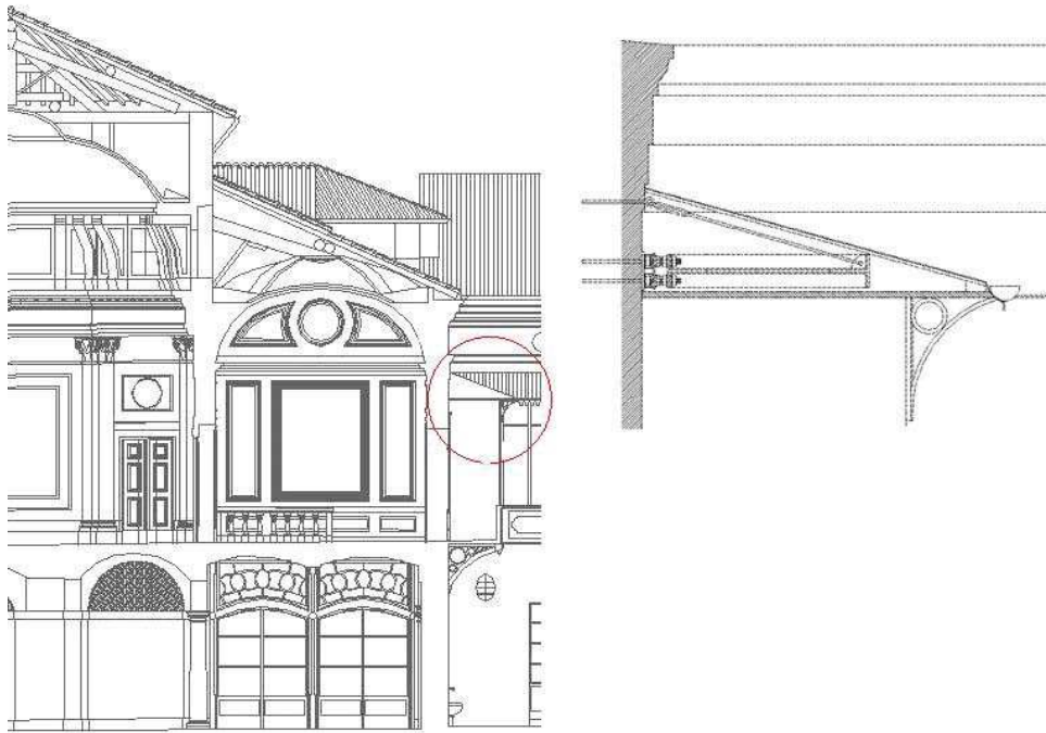
Figura 31 La trave "a coltello" che contrasta le spinte della volta
