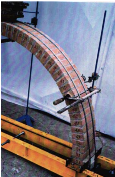
Figura 21 “Arco armato”: dettaglio dei cavi di armatura estradosali
