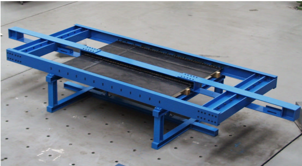
Fig. 3. Banco con solaio in legno parzialmente montato (a) e con la lamiera applicata sull'assito (b).
