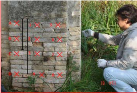
Figura 4.22. griglia ortogonale di battute e di ricezione di un pilastro per le prove soniche dirette
