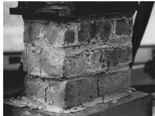
Figura 3.5. Collasso di un provino di muratura
