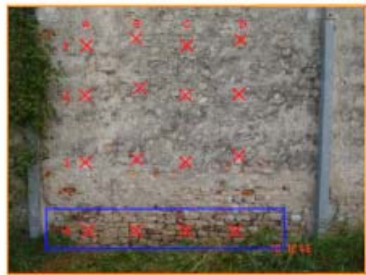
Figura 4.10. confronto delle misure orizzontali della prima riga e l'immagine del dettaglio muratura della zona A con evidenziata la griglia ortogonale di battute e di ricezione
