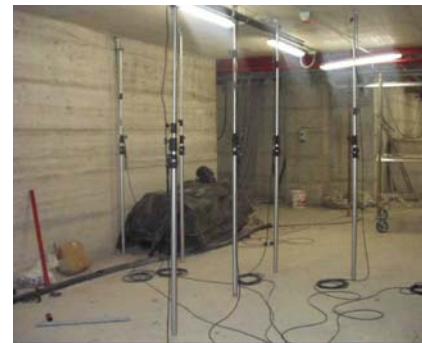
Figura 27: rilevatori di spostamento telescopici
