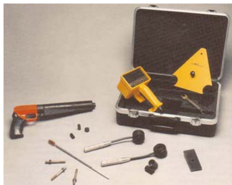
Figura 3: Strumentazione per la prova di penetrazione con sonda Windsor.
