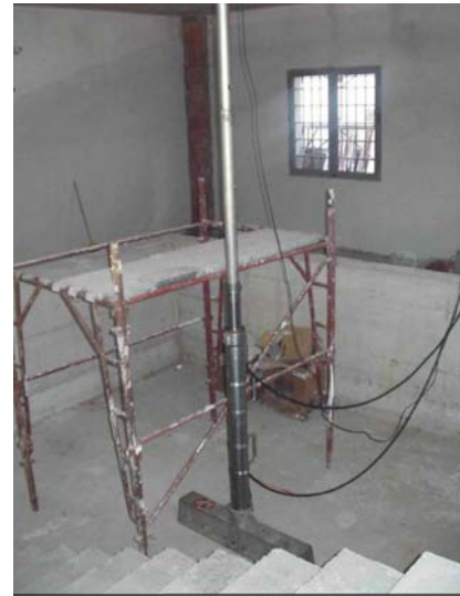
Figura 25: applicazione del carico con pistone oleodinamico
