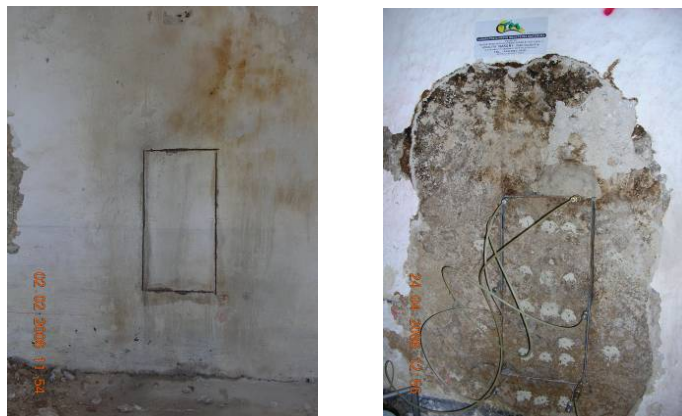
Figura 20: Prova a taglio con 6 martinetti piatti
