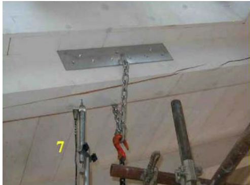
Figura 29: Trasduttore di mezzeria e sistema d'ancoraggio
