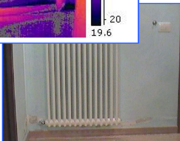
Figura 11 Estratto dal test report – evidenza della presenza dell’umidità – confronto visibile/IR (siamo a piano terra, la parete è rivolta a Nord, la pavimentazione è in legno sbiancato, la parete finita a marmorino)
