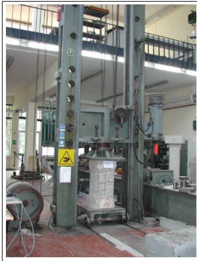
Fotografia 7. Le prove sulla capacità portante dei pilastri
