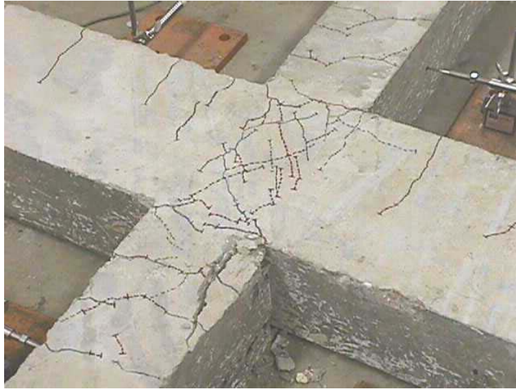
Figura 10. Crisi del nodo per schiacciamento del calcestruzzo nelle colonne
