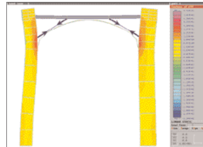
18. Modello agli elementi finiti che illustra l'effetto di contenimento della "graffetta".
