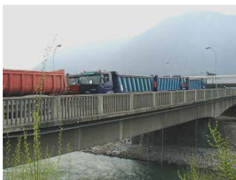
Fig.10: Prove di carico statiche e dinamiche
