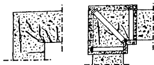
Fig. 15.82. — Consolidamento dei nodi trave-pilastro: disposizione di staffe piatte e strato di malta.
