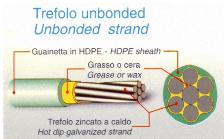
Fig. 3 – Sezione tipica di trefolo “viplato” utilizzato per la composizione di stralli da ponte a trefoli paralleli.
