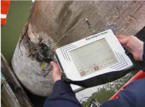
Martello e accelerometro in nicchia unica
