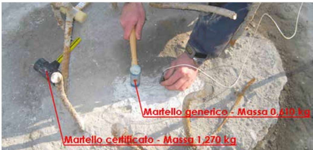
Esecuzione indagine con martelli di masse diverse
