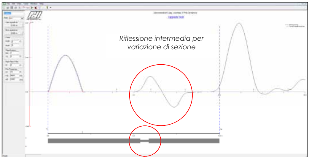
Palo con diminuzione di sezione a quota 5,5 m
