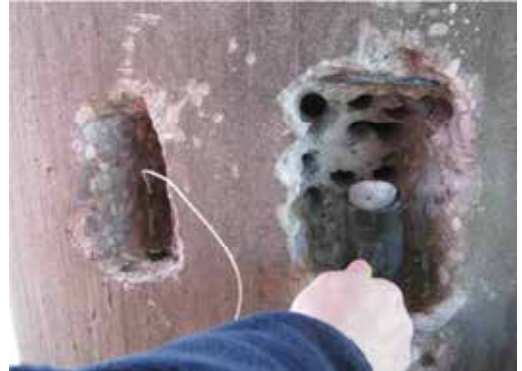
Martello e accelerometro in nicchie separate
