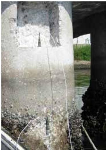
Predisposizione di doppio accelerometro sul fusto del palo
