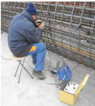
Saldatura degli estensimetri
