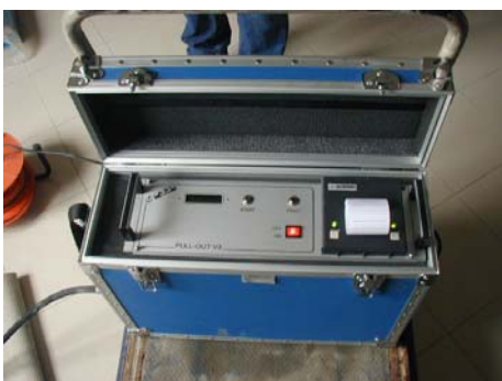
Centralina acquisizione dati
