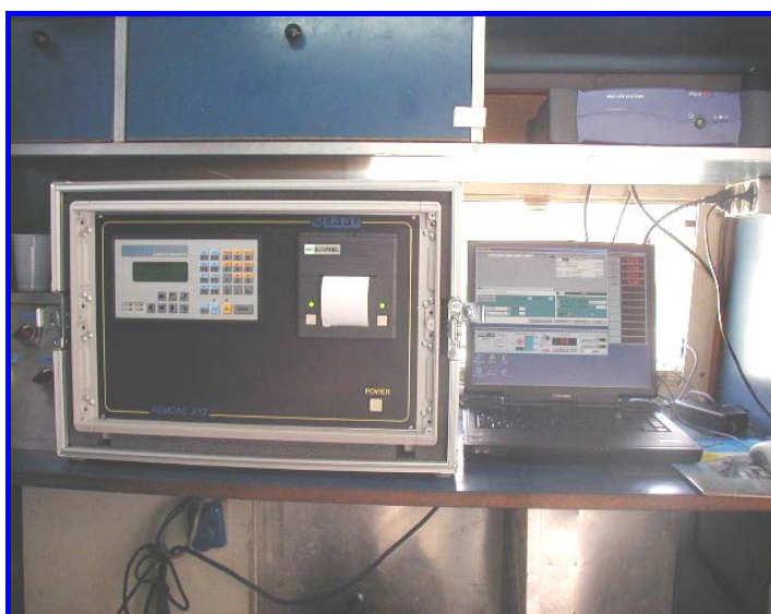
Foto 1: acquisitore GS 04 interfacciato con P.C.
