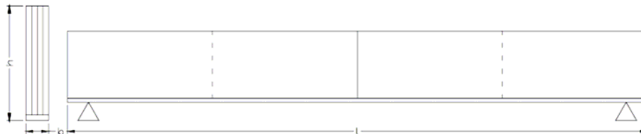
Figura 12. Schema di una trave "lamellare" in vetro.
