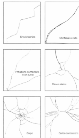
Figura 5. Principali modelli di rottura di un vetro e relative cause.
