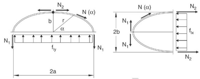
Fig. 4. Equivalent confinement pressures.
