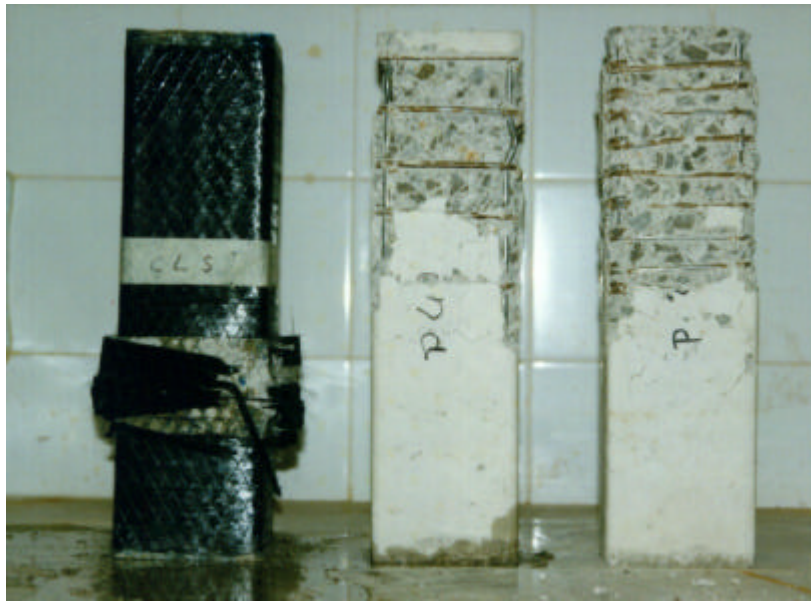
Fig. 8. Modo di rottura dei prismi rinforzati con CFRP e con staffe.
