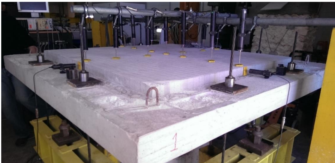
Immagine prototipo lastra rinforzata con camicia superiore in c.a. prima della prova
