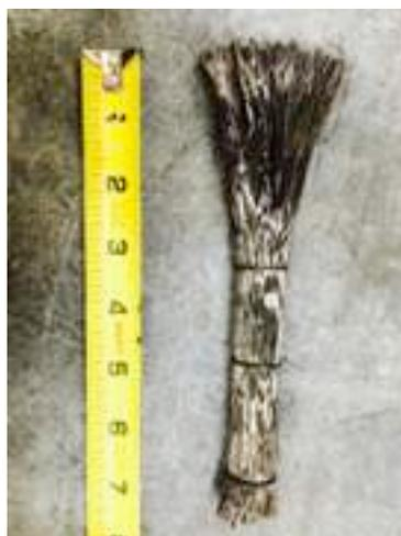
**Figure 1 - Tipico Connettore (Righello in Inch)**
