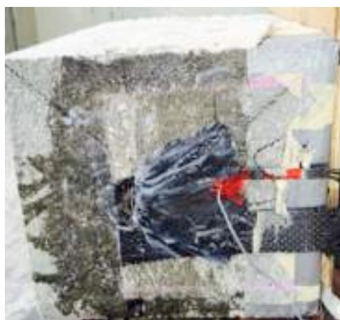
**Figure 12 - Test 3 - Debonding e rottura della lamina**
