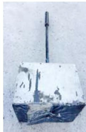
**Figure 10 - Test 2 - Rottura del ventaglio e debonding della lamina dal substrato**
