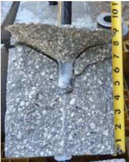
**Figure 11 - Test 1 - Cono di rottura e splitting del provino**
